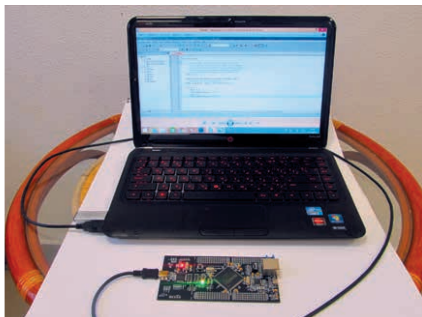
Рис. 6. Подключение отладочного комплекта к компьютеру
